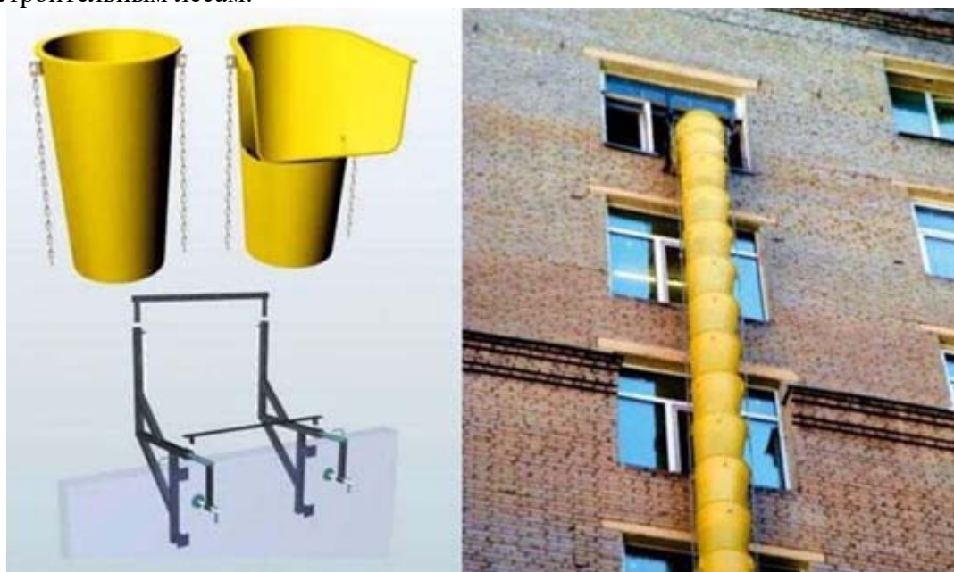
Рис.1. При помощи струбцин кронштейны могут закрепляться в оконных проемах
